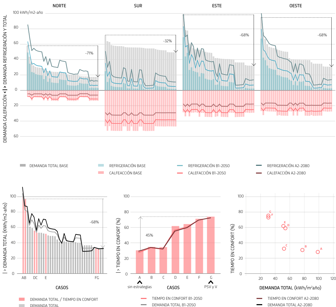
FIGURA 36> Demanda energética por orientación en período base y escenarios B1-2050 y A2-2080 (arriba). Casos en orientación Este según demanda de energía, tiempo en confort y comparativo de ambos indicadores (abajo). Fuente: elaboración propia.
