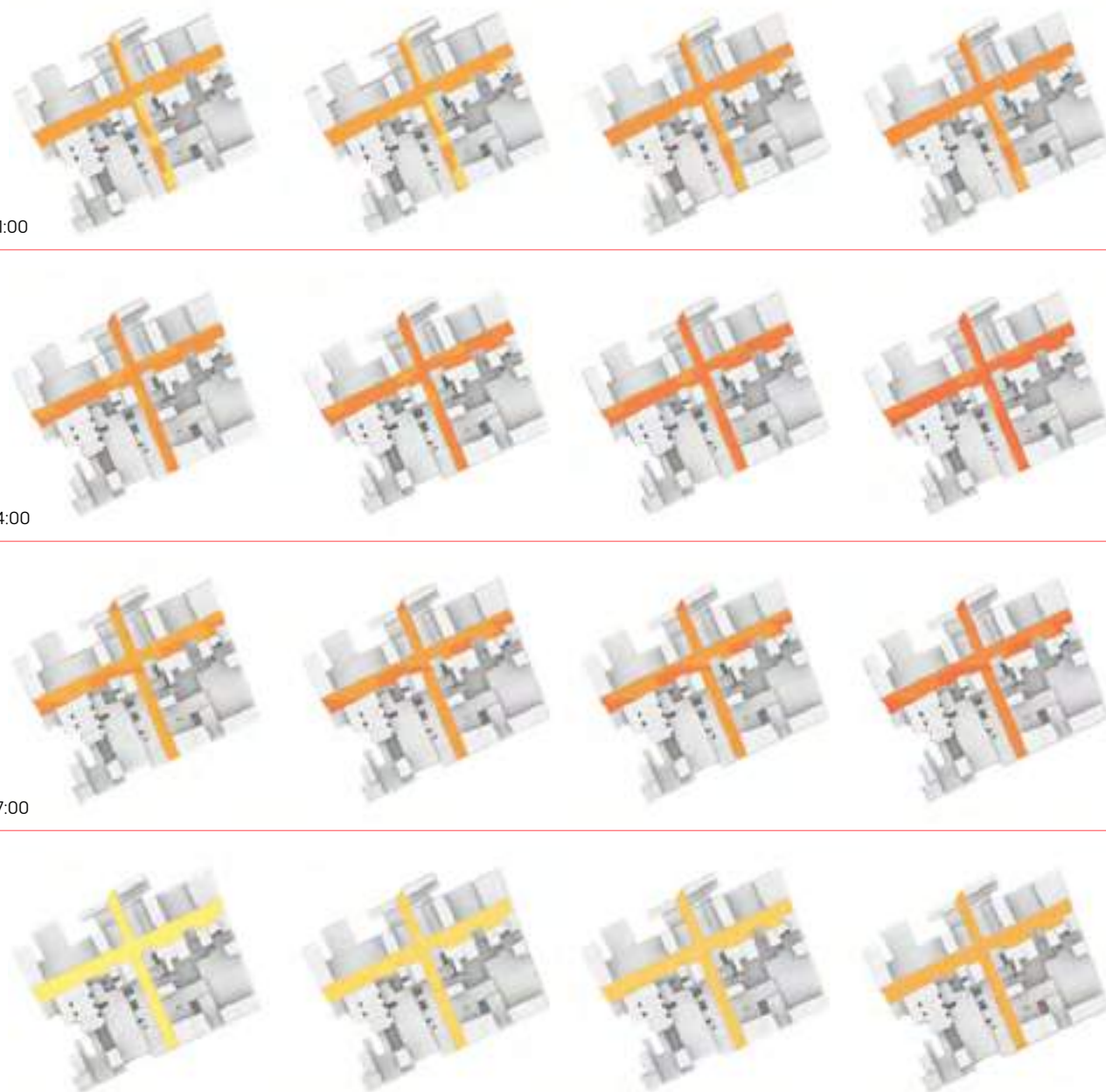
FIGURA 31> Comparativo de temperatura equivalente UTCI en Cordon, Montevideo, en período base y cuatro escenarios futuros (B1-2050, B1-2080 y A2-2080) y cuatro cortes temporales (11, 14, 17 y 20 horas). Fuente: elaboración propia.
